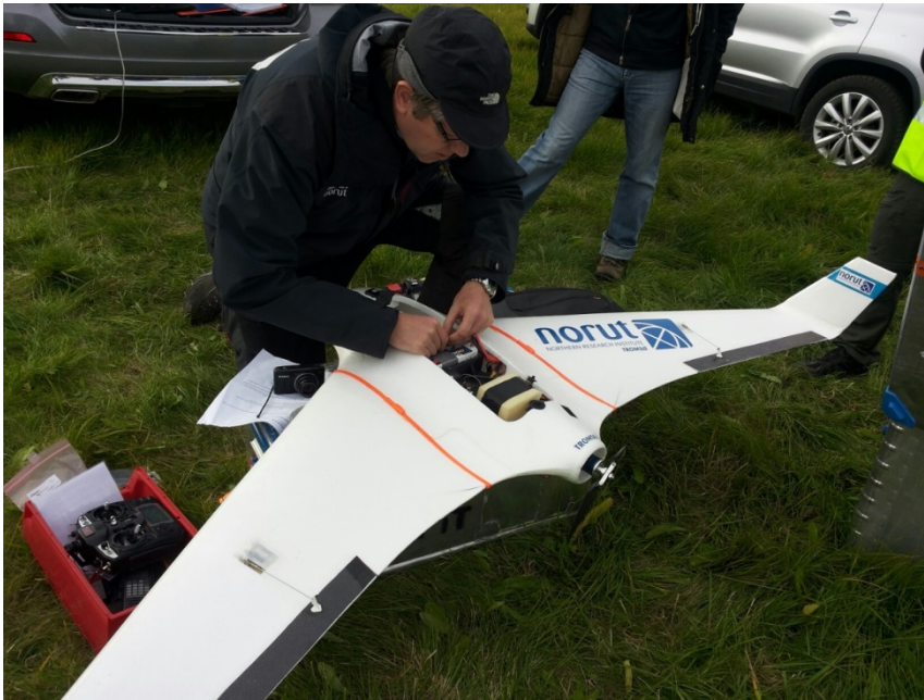
Mynd 5. CWM 8X dróni Noðmannanna búinn undir mælingu í North State verkefni. Flygildið er úr frauðplasti með 2,10 m vænghaf, getur borið 2 kg og um borð eru tvær myndavélar. Flugtími í hverri mælingu er tæpur hálf tími og flughæðin venjulega 200-300 metrar.
